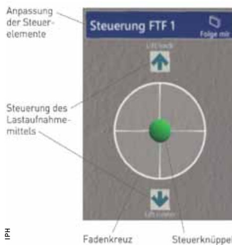
4 Virtuelle Steuerelemente zur gestenbasierten Steuerung eines Fahrzeugs
