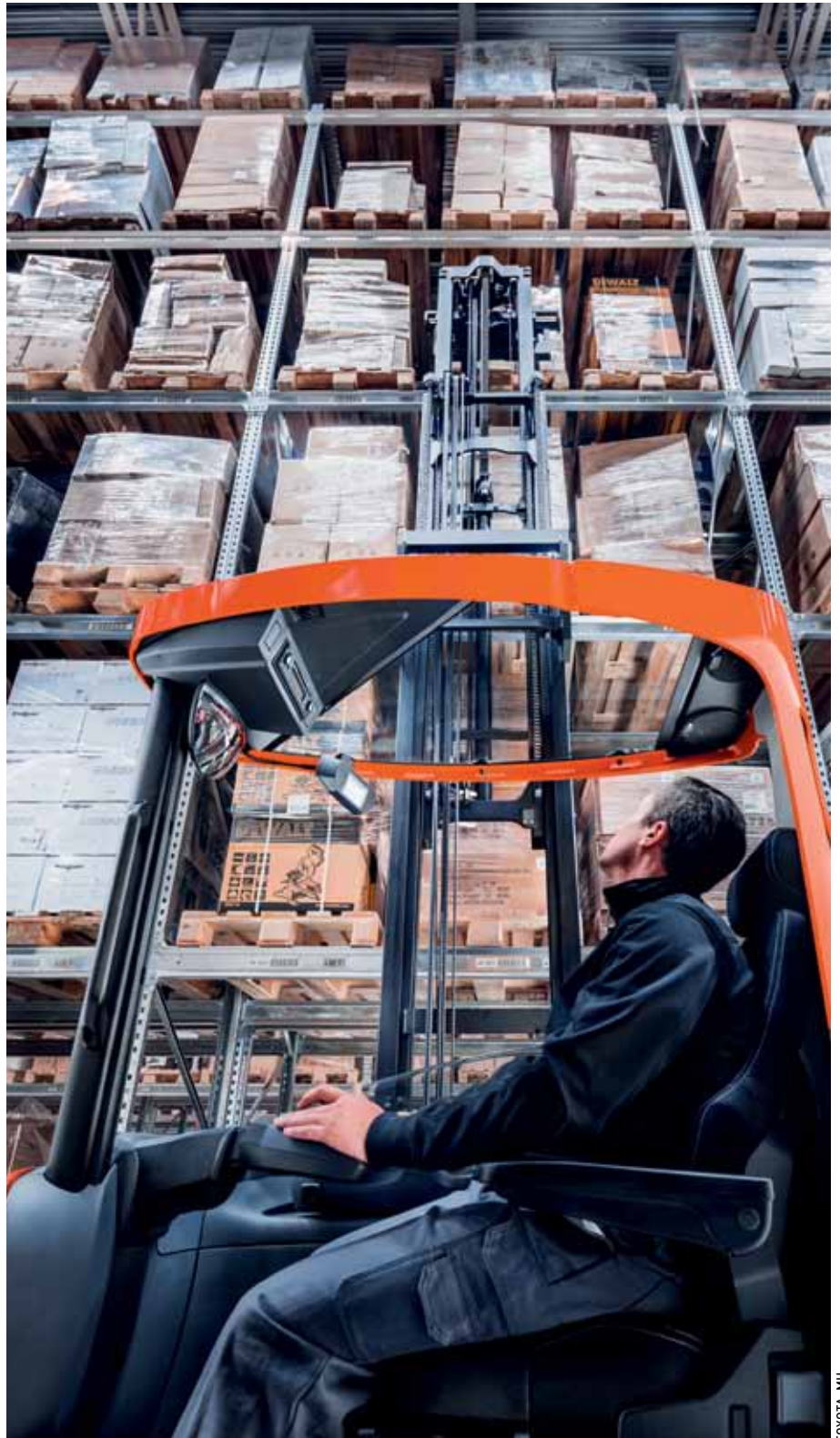
Das serienmäßig verbaute Fahrerschutzdach des „BT Reflex“ mit fächerförmigen Stahlstreben ermöglicht beste Sicht nach oben und bietet zusätzlichen Schutz.
