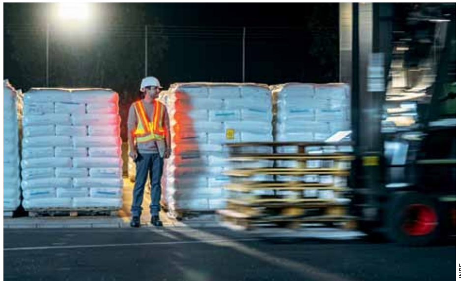
Sehen, hören, spüren: Mit der „Interaktiven Warnweste“ werden Fußgänger rechtzeitig auf herannahende Flurförderzeuge aufmerksam gemacht.
