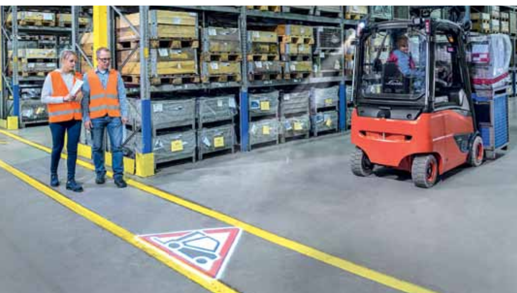
Der „Truckspot“ von Linde ist eine Weiterentwicklung des „Bluespots“. Das optische Warnsystem projiziert ein rotes Dreieck hinter sich auf den Boden und weist andere Personen auf einen nahenden Stapler hin.
