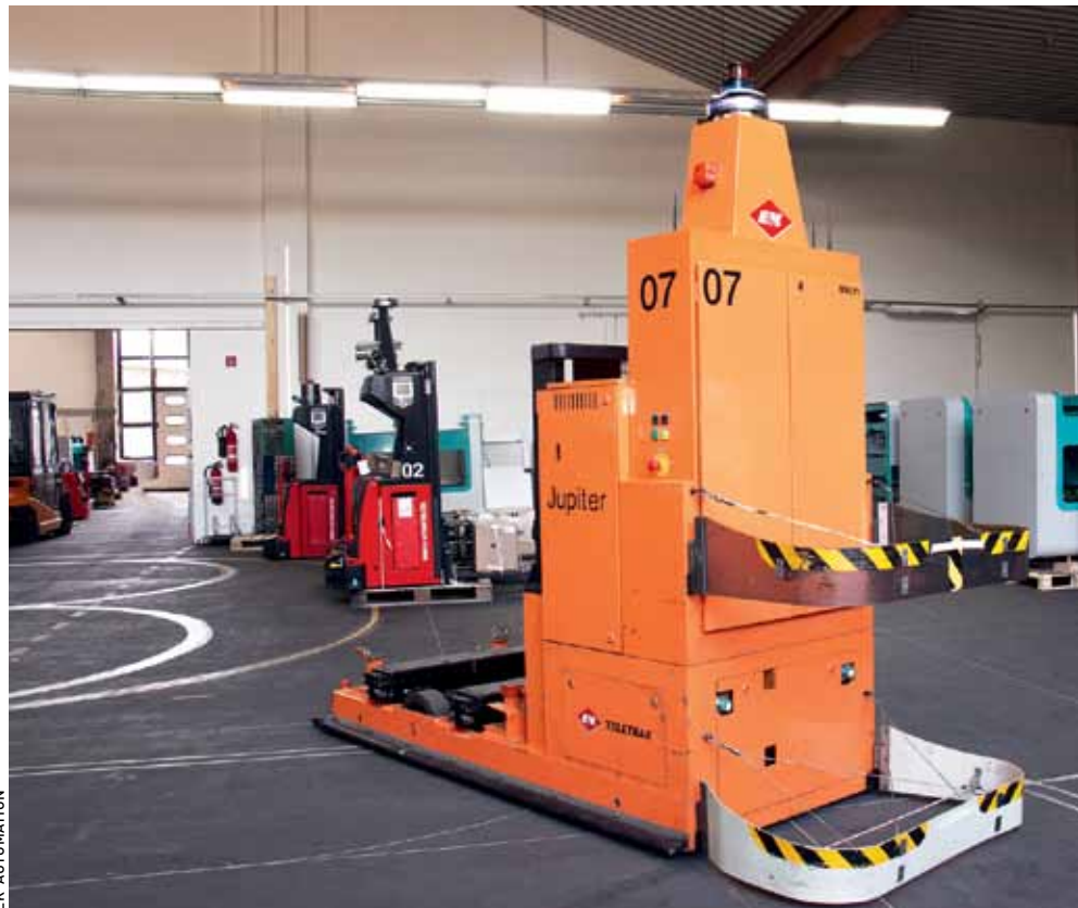
Refit bedeute bei dem Spezialisten für Transportrobotik nicht, dass bei den Fahrzeugen nur punktuell Bauteile ersetzt werden, wie etwa bei einer der regelmäßigen Wartungen. Die automatisierten Transport-, Hub- und Schleppfahrzeuge werden komplett überholt.
