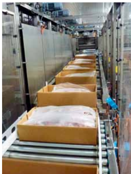
NCMC-Kartons mit handelsgerechten Fleischportionen auf Dematic-Förderer.
