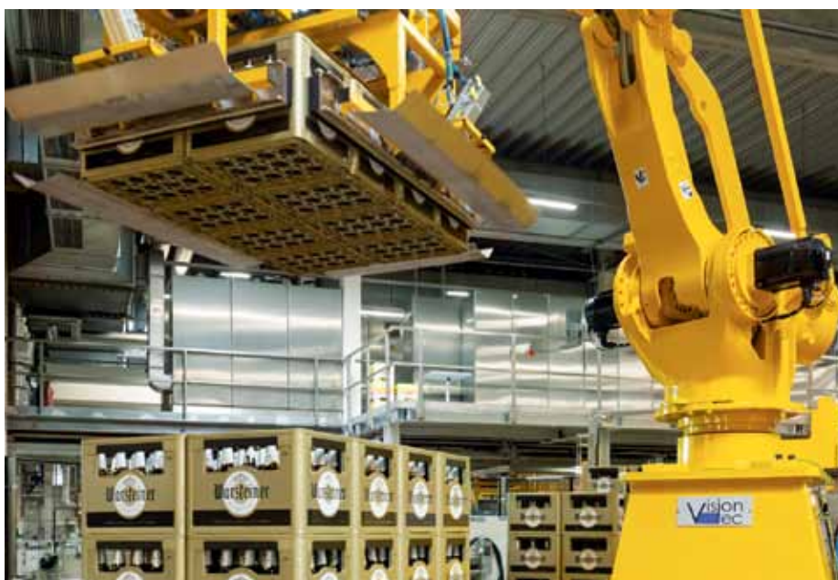
Der „Motoman MPL500 II“ ist mit einem Parallelgreifer ausgestattet.
