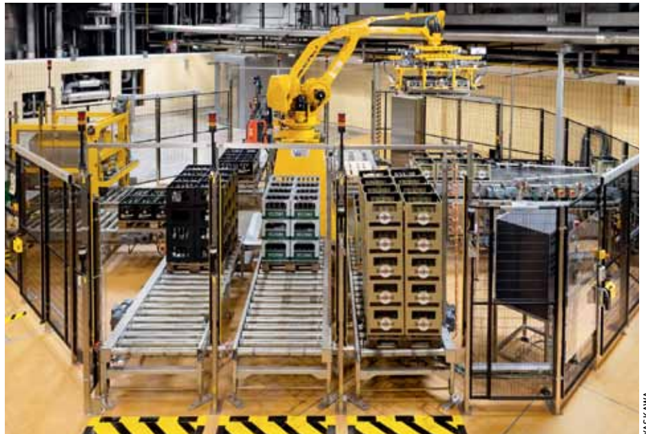
Der Roboter steht – buchstäblich – im Zentrum der Anlage: Um den Manipulator sind sternförmig acht Palettierpositionen angeordnet.
