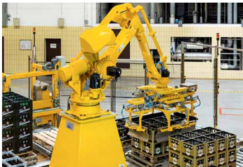
Während eine fertige Palette in der Abholposition auf ihre Abholung wartet, wird in der Beladeposition bereits die nächste Leerpalette positioniert.
