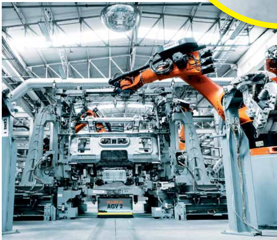
Flexibles Fahrerloses Transportsystem im Lkw-Montagewerk Türk von Mercedes-Benz in Aksaray
