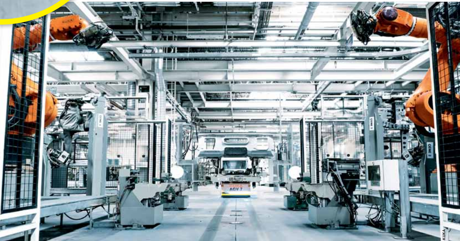
Die mobile Plattform 1500 lädt zeitgleich zu den Montageabläufen mittels Bodenladeplatten direkt in den Prozessstationen.
