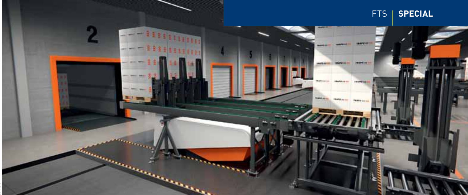
1 Das TLS 3600 übernimmt vom Kettenförderer gleichzeitig drei Paletten.
