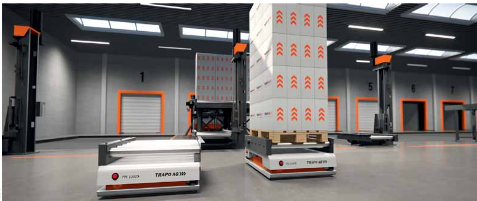
4 Fahrerlos: Mehrere TTS 1200 mit Rollenförderer-Aufbau bringen die einzelnen Paletten zum TLS 3600.
