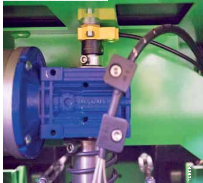
Am Motor der Lenkung erkennt Turcks berührungsloser Winkelgeber den Lenkeinschlag.
