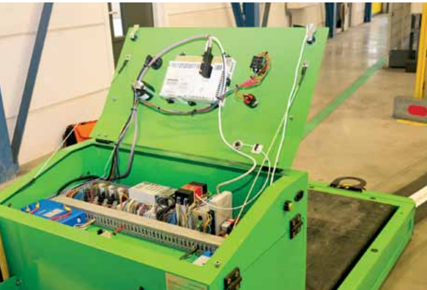
Turcks VT250 ist im Deckel des Schaltkastens verbaut. Es kommuniziert über Modbus-TCP kabellos mit dem IMS und steuert nahezu alle Systeme des Fahrzeugs.
