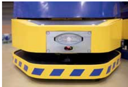
Integrierte Sicherheits-Laserscanner sorgen für die erforderliche Orientierung und überwachen fortwährend den Fahrbereich.
