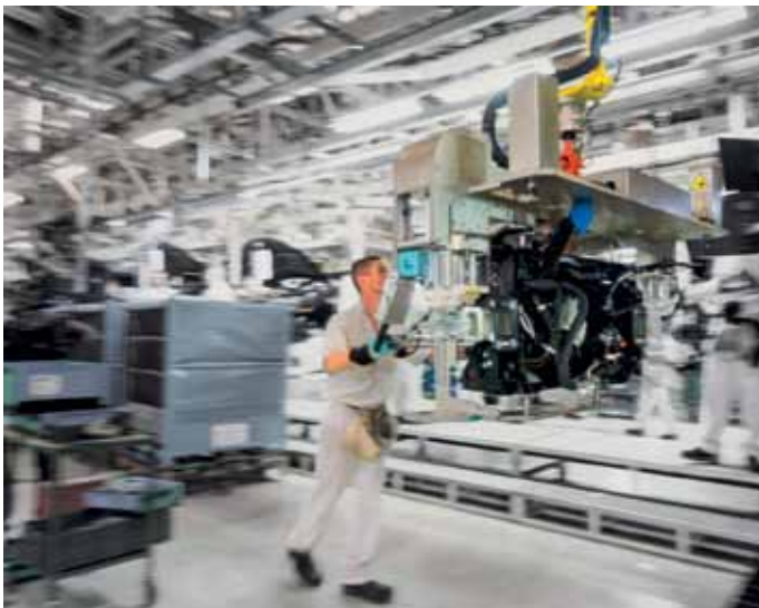
Hängende Fördereinrichtung zur Reduzierung der genutzten Fläche am Boden und um eine Bearbeitung des Produkts von allen Seiten zu ermöglichen
