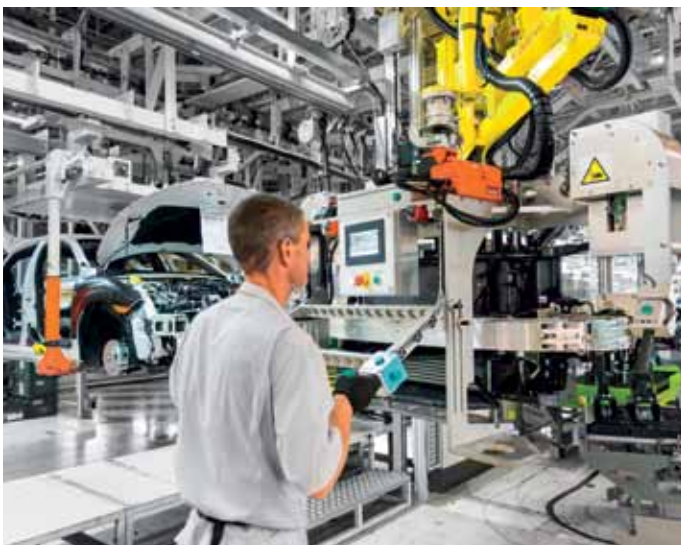
Werkzeuge und Tragarme an hängenden Fördereinrichtungen zur Handhabung neuer Fahrzeugmodelle und Baugruppen
