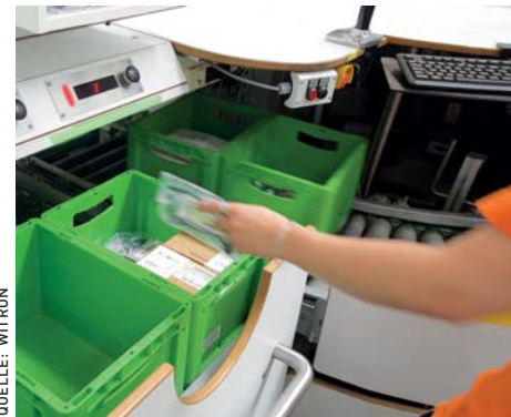
2 Flächen-Scanner und ein Pick-by-Light-System gewährleisten eine hohe Kommissionierqualität.
