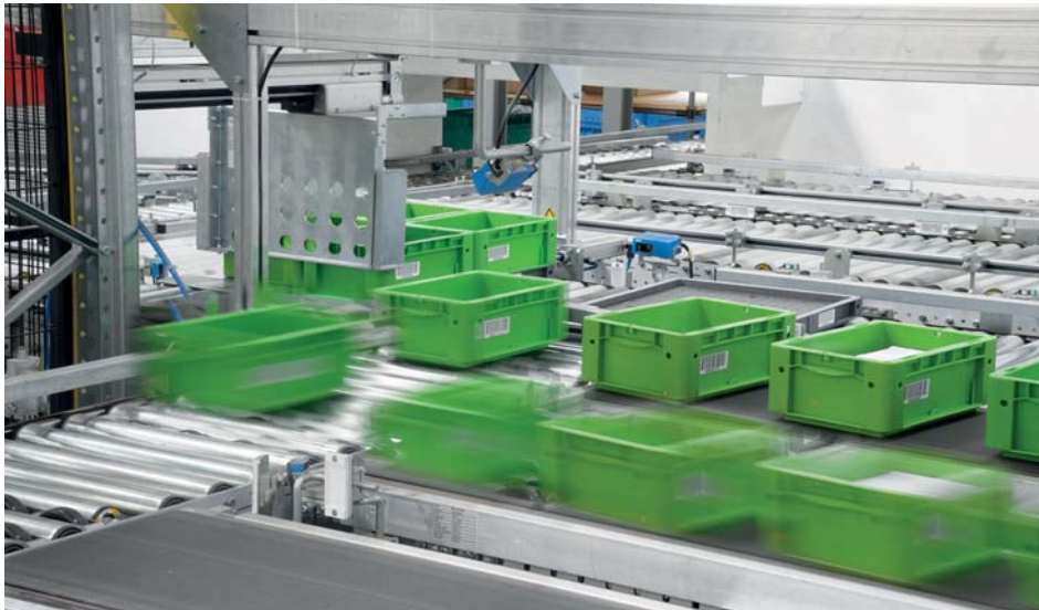
5 Die Verdichterstation für leere Ladungsträger ermöglicht eine maximale Nutzung der Lagerkapazitäten.
