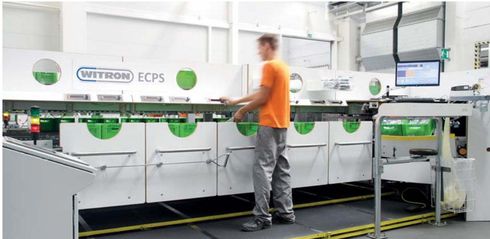
1 Die Škoda-Mitarbeiter können bis zu zehn Kundenaufträge gleichzeitig kommissionieren.
