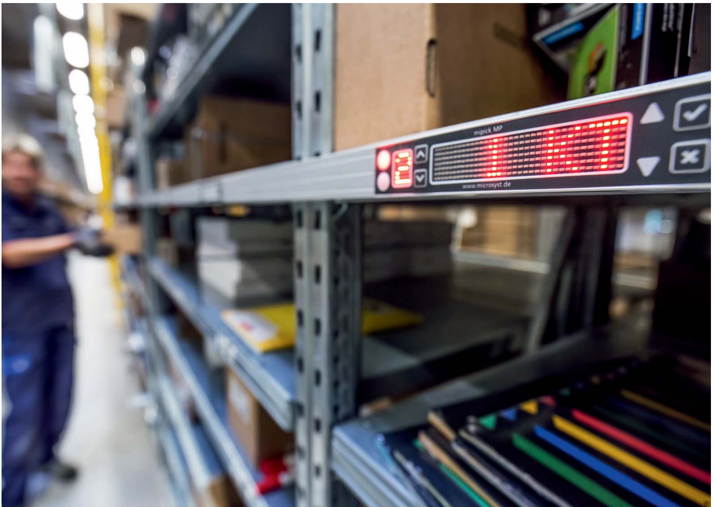
5 Über die Pick-by-Light-Anzeigen erfährt der Mitarbeiter die Ebene und Anzahl der zu pickenden Artikel.
