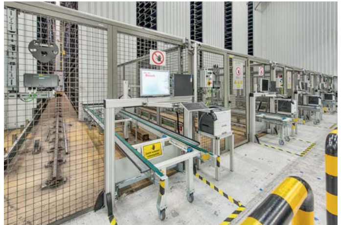
4 Es wurden die Auslagerungsstrecke des AKL erweitert, die drei Kommissionierplätze an die Fördertechnik angeschlossen und Schutzzäune an der Anlage eingerichtet.
